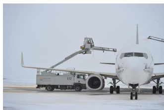
Enteisung am Flughafen Leipzig/Halle
